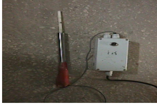
Resim 4. Deneylerde kullanılan yer değiştirme ölçüm sistemleri.
