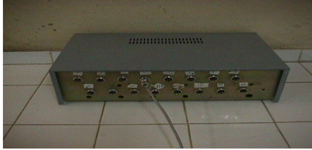
Resim 5. Yük ve yer değiştirme okumalarını değerlendiren data logger sistemi.
