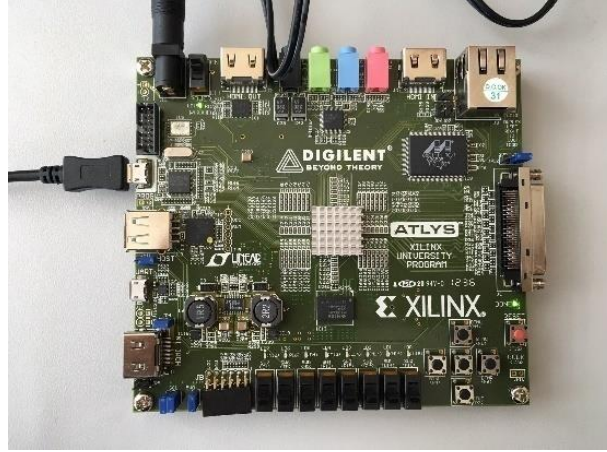
Şekil 4. Xilinx Atlys Spartan-6 Geliştirme Kartı
