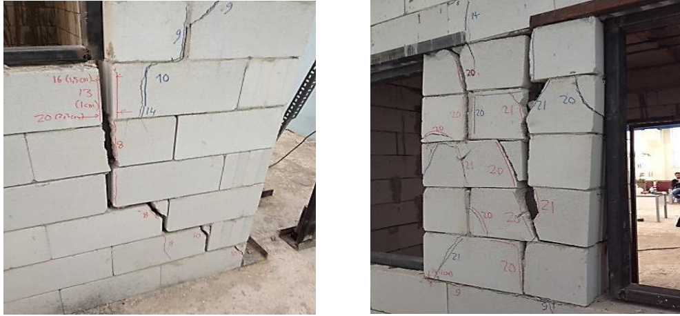
Şekil 6. Deney sonu itibariyle maksimum hasar durumları
