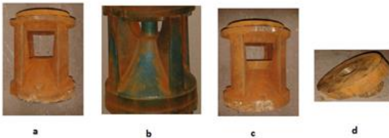
Şekil 3 M 1 pompasına ait farklı giriş ağız kesit alanları (a: %20 büyütülmüş, b: orijinal, c: %20 küçültülmüş) ve değiştirme burcu (d)
