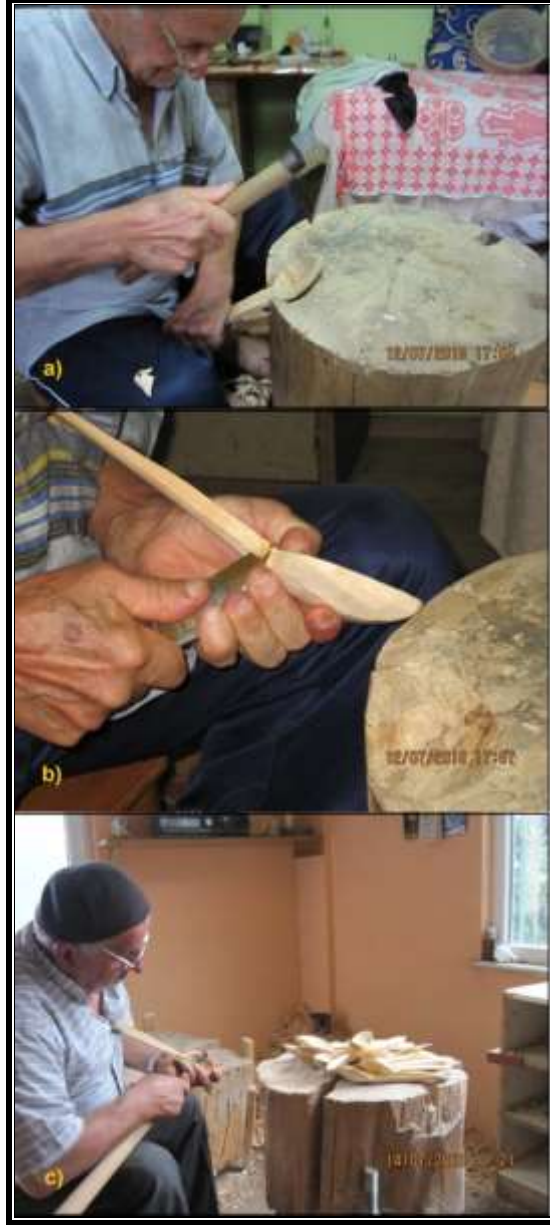
Fotoğraf 3. Kaşık imalatının aşamalarından: a) Keserle taslak halindeki kaşığın ağız kısmının oyulması, b) Özel ahşap bıçakla sapının düzeltilmesi, c) Eğdi denilen bıçakla kaşığın içinin pürüzsüz hale getirilmesi
