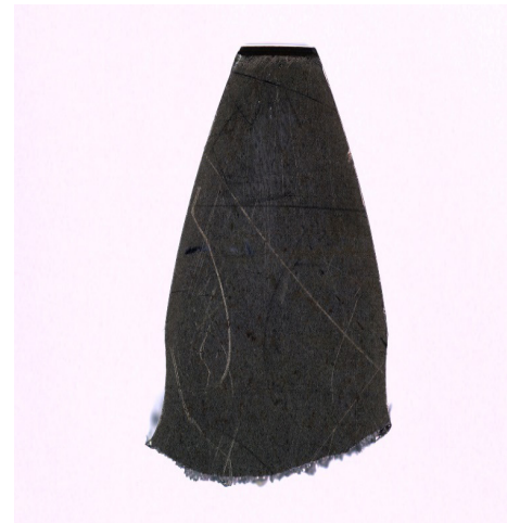
Şekil 14. Silindirik düz dişli çarkın dişinin hasar görünümü
