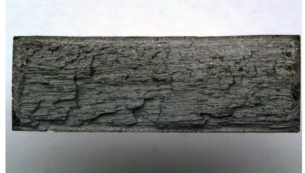
Şekil 12. Bir bilye-püskürtülmüş, yüksek-sertlikli dişli çarkın dişinin kırılma yüzeyi
