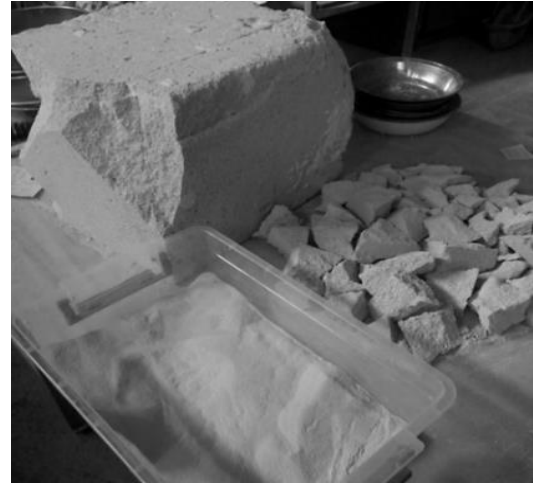
Şekil 1. Öğütülmüş gazbeton atıkları
