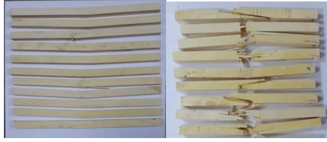
Şekil 3. Test örneklerinin test sonrası görüntüsü (A: eğilme direnci, B: şok direnci)
