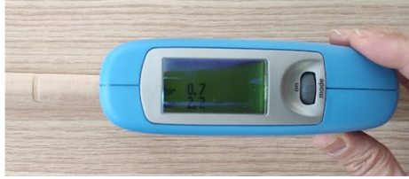
Şekil 3. BYK Gardner parlaklık ölçüm cihazı
