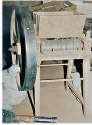
Görsel 7. Kilin inceltilmesi için kullanılan vals.
