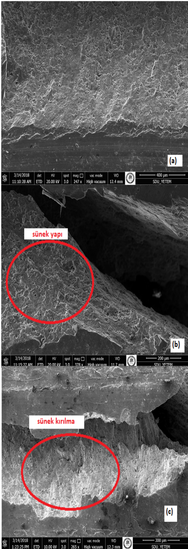
Şekil 9. 190 °C’de değişik işlem sürelerinde ((a) 4 saat; (b) 12 saat; (c) 20 saat) yaşlandırma işlemi uygulanmış TY numunelere ait SEM görüntüleri
