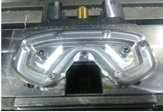
Şekil 16. İşlenmiş yeni kalıp elemanı
