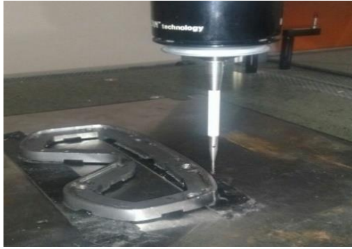
Şekil 4. Kalıp elemanının 3D Taranması
