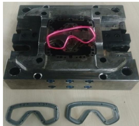
Şekil 17. TM ile üretilmiş yeni kalıp elemanın deneme baskısı ve kalıp
