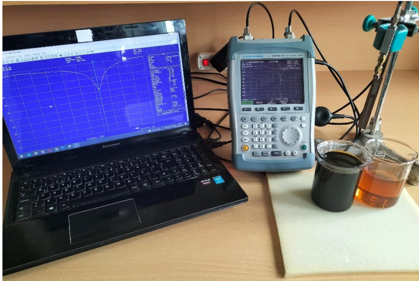
Şekil 4. Geri Dönüş Kaybı Ölçümleri İçin Motor Yağı Numune Ortamı ve Önerilen Antenin Motor Yağı İçerisindeki Farklı Uzunluk Seviyeleri(a) ile Sensör Ölçüm Düzenliği (b) (Engine Oil Sample Medium for Return Loss Measurements and Sensor Measurement Setup (b) with Different Length Levels of the Proposed Antenna in Engine Oil (a))
