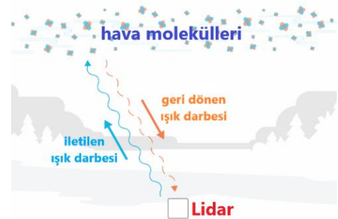
Şekil 2. Doppler rüzgâr LIDAR'ı çalışma prensibi
