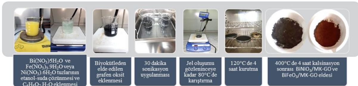
Şekil 2. Mısır Koçanından Elde Edilen Grafen Oksit Adsorbent ve Katalizör Destek Malzemesi Hazırlanış Adımları
