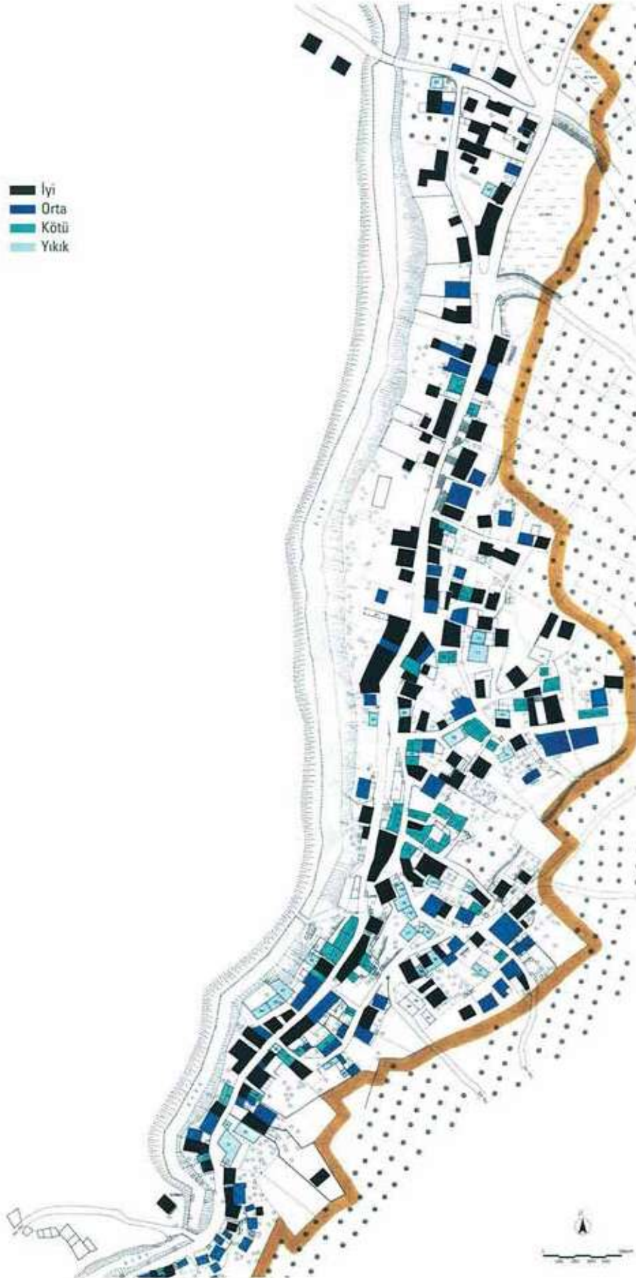
Şek. 11. Karsak köyündeki yapıların sağlamlık durumu analizi.
