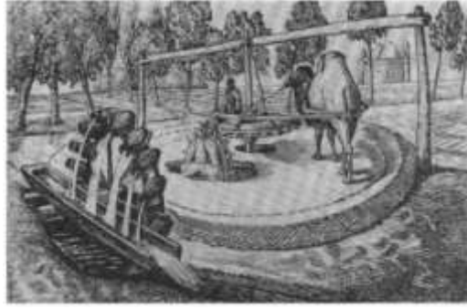
Suyun kuyulardan çıkarılmasına yarayan sakiye, Çigir(Sakiye)- X-XII yüzyıllarında Otrar vahasında. V.A.Troşev tarafından yeniden yapılanma; sanatçı A.E. Gorbatov
