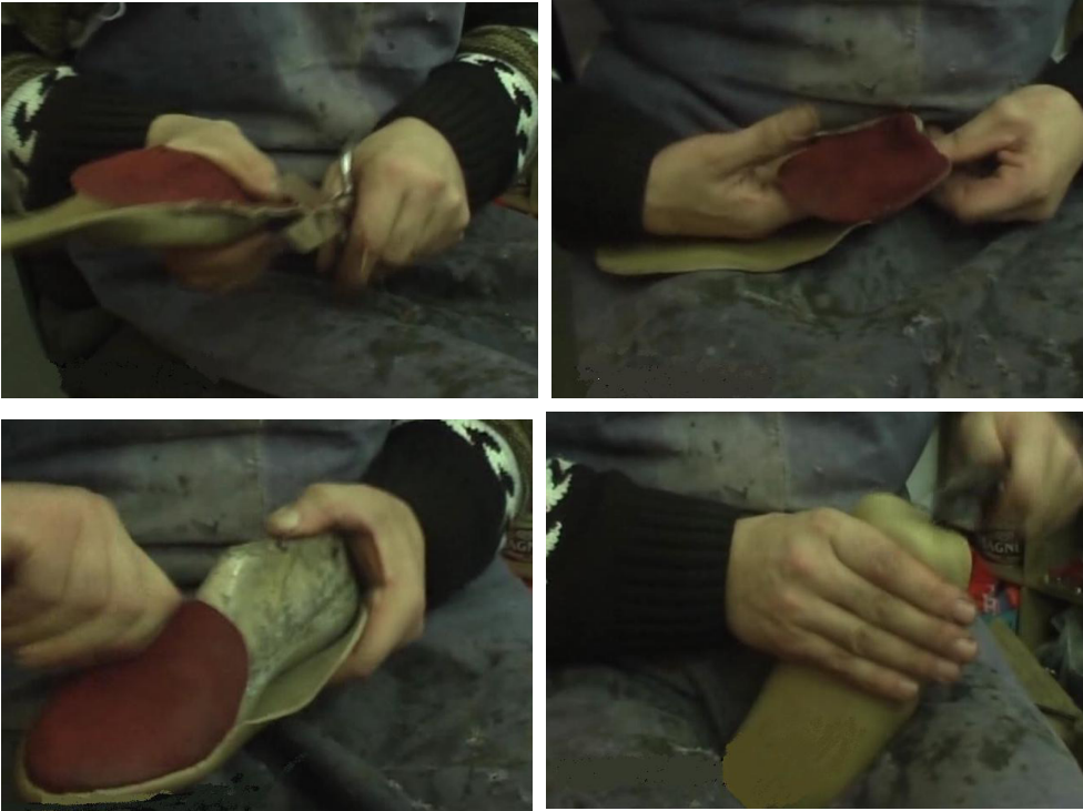
Şekil 4. Çarığın kalıba gerilmesi
