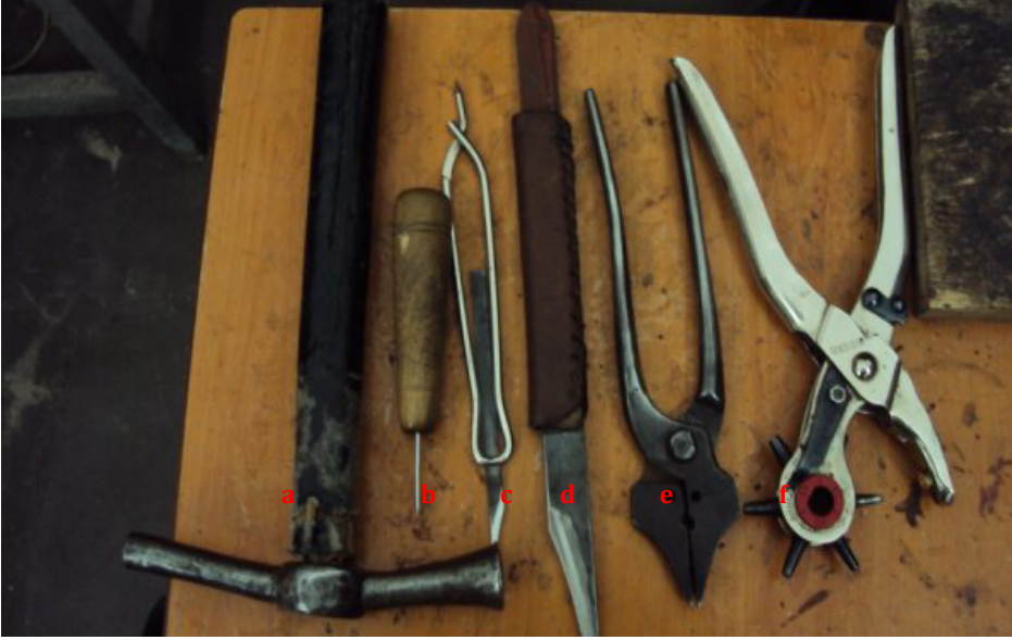
Şekil 1. Çarık yapımında kullanılan bazı araçlardan genel görüntü (a. çekiç, b. biz, c. deri kesim bıçağı, d. bıçak, e. danayla, f. çarklı zımba)
