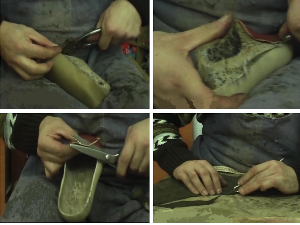
Şekil 5 . Kalıpta şekil almış ayakkabının fazlalıklarının kesilmesi
